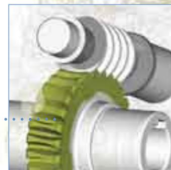
A fin de mejorar el nivel de ruido, rendimiento y duración, el eje tornillo sinfín está fabricado en acero tratado, mientras que la corona está fabricada en aleación de bronce.
