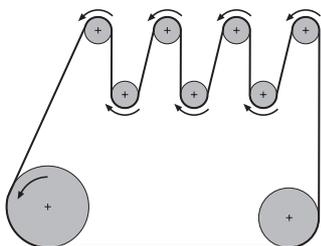
La correa SPEEDFLEX® es ligera y acepta altas velocidades sin que la fuerza centrífuga reduzca exageradamente la capacidad de transmisión. Al ser simétrica, se enrolla indistintamente en un sentido u otro y es idónea para las transmisiones alternadas. Como es plana, se adapta a los diámetros más pequeños y permite transmisiones de gran relación. Disponible en tres tipos y numerosas longitudes, cortada a la anchura necesaria, la correa plana SPEEDFLEX® cubre una amplia gama de potencias.
