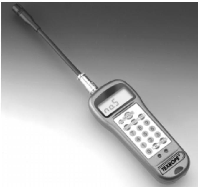
El tensímetro sónico analiza las ondas sonoras producidas por las vibraciones de una correa. Una correa vibra a una cierta frecuencia, determinada por su tensión, su peso y la longitud del ramal. El tensímetro mide esta frecuencia y la convierte en un valor de tensión.
